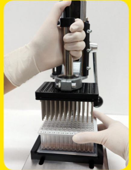
Press pipettor와 adaptor tip 장치와 분리가 쉽고 간편
