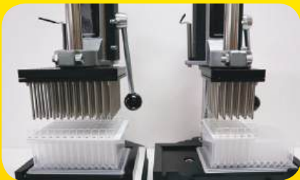
2가지 type [ 96well, 48well ] (Magnetic Press Pipettor로 한번에 96개, 48개 시료처리 가능)
